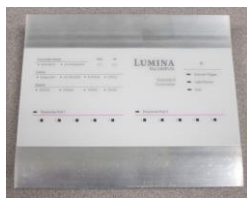
タイミングコントローラ (Cedrus Lumina製) : 撮像と連動した刺激提示 タイミングを調整
