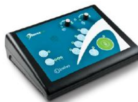
SensaVue オペレーター コントロール : 音量の調節やSensaVue モニターに出力する画面のミ ラーリングを調整
